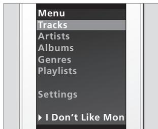
Display del menu principale – il titolo del brano che viene riprodotto appare sempre nella parte inferiore del display. Il colore del cursore indica lo stato della batteria.
